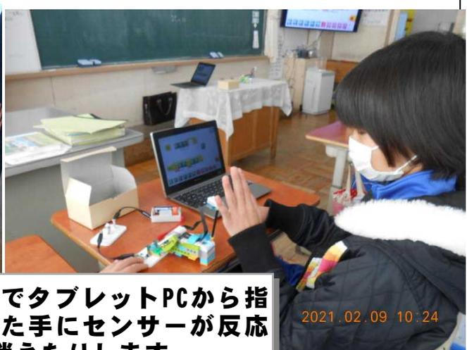
組み込んだプログラムでタブレットPCから指令を送ると、かざした手にセンサーが反応し、明かりがついたり消えたりします。
